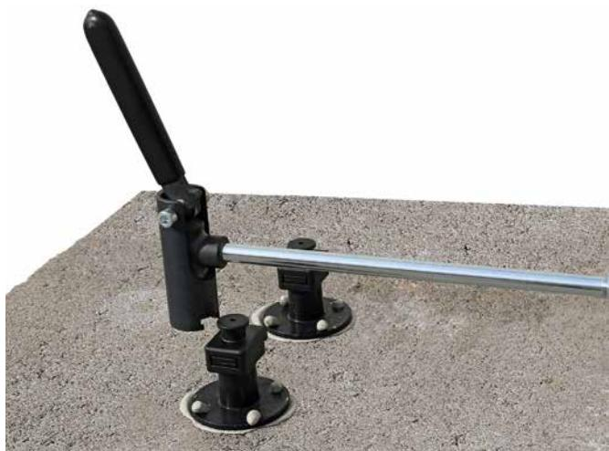
DESOI Z-Slider auf den Flachkopfnippel schieben
