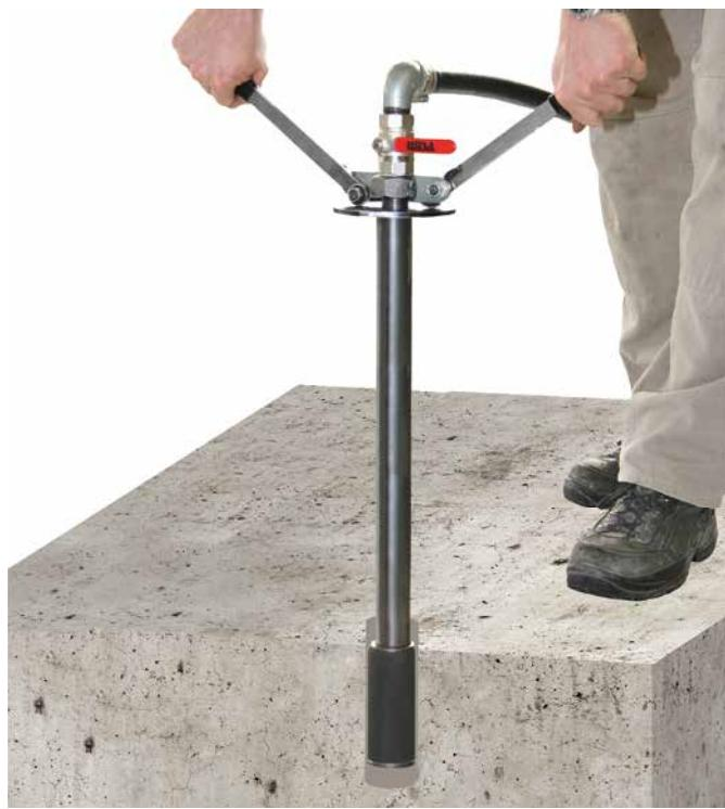
Der Schnellspannpacker wird für die Injektion unter Bauteilen, z. B. unter Bodenplatten eingesetzt. Durch Betätigen der Spannknebel wird der Packer sicher gespannt, die Spannposition bleibt dabei erhalten. Während der Injektion bleibt der Schnellspannpacker über den Kugelhahn und den Materialschlauch fest mit dem Injektionsgerät verbunden.
